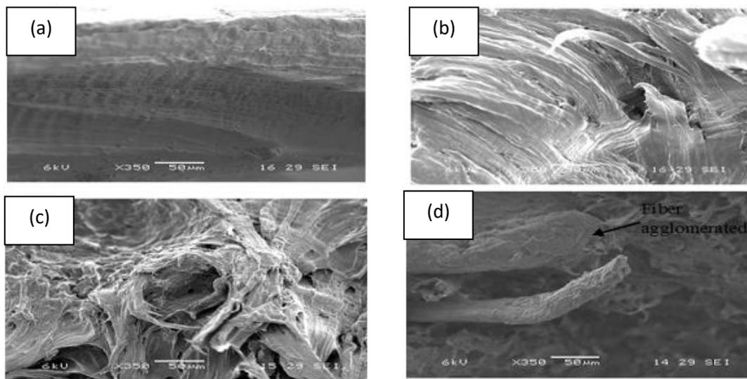
**Fig. 2** SEM micrographs of (a) LDPE, (b) LDPE/TPS, (c) LDPE/TPS/10 wt.% BPF and (d) LDPE/TPS/40 wt.% BPF
